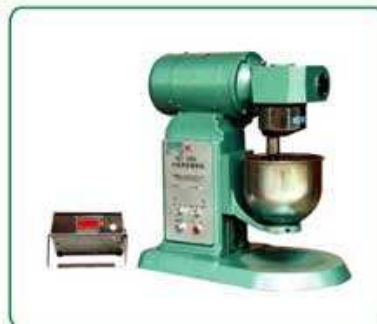
水泥净浆搅拌机NJ-160A 按规定的水泥和水混合后搅拌成均匀的试验用净浆，供测定水泥标准稠度、凝结时间及制作安定性试块用。产品符合GB3350.8、JC/T729标准要求。
