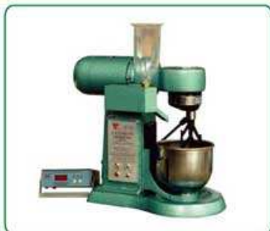
水泥胶砂搅拌机JJ-5 主要用于水泥胶砂试件制备时的搅拌。产品符合GB3350、GB/T17671-1999、BS3892、ISO679标准要求
